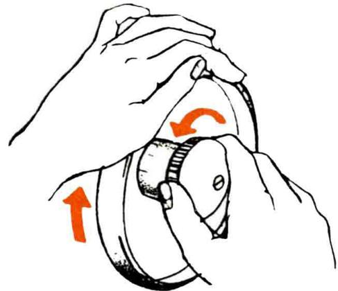
b. Coloque el carrete vacío en el eje o perno. El eje tiene una pequeña cuña que debe entrar en la ranura del carrete.
