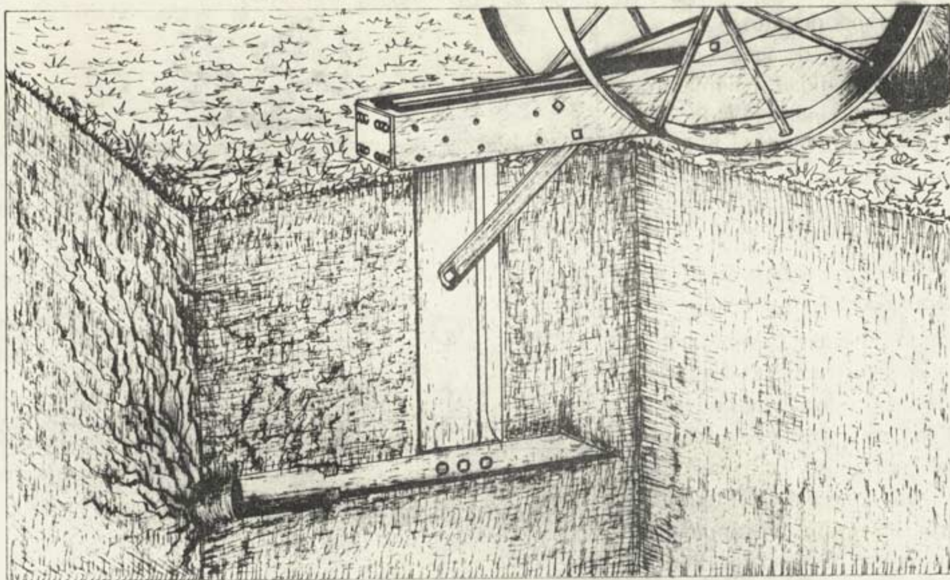
CANALES SUBTERRANEOS DE DRENAJE ABIERTOS CON EL ARADO TOPO Y AGRIETAMIENTO DEL TERRENO QUE ACTUA COMO DRENES SECUNDARIOS
