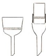
Tubos para pruebas de filtración con lana de vidrio
