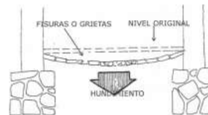
Deterioro por hundimiento causado por daños en la estructura portante.
