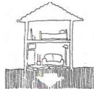
Deterioro por hundimientos causados por sobrepeso.
