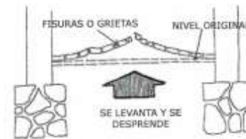
Deterioro por levantamiento y desprendimiento del piso.
