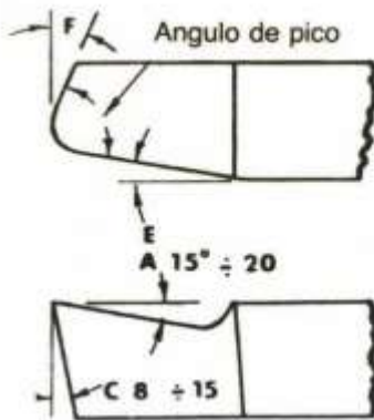
Fig. 4 Ángulos de una herramienta de un solo filo.
