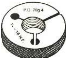
Fig. 6 Galga para perfiles de rosca de tornillo sinfín Brown & Sharpe y galga para situar la herramienta destinada a tallar dicha rosca (Brown & Sharpe Mfg. Co.)
