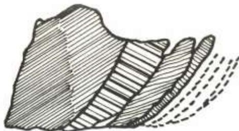
3. Que el arranque de la viruta se produce cuando el filo de la cuchilla (Fig. 3) corta el vértice del cono CBO que dejó la viruta anterior.
