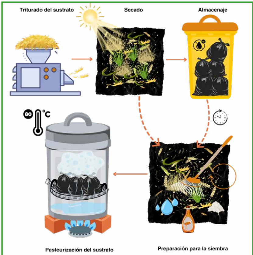
Adecuación y pasteurización del sustrato. Esquema hecho con Canva Pro.
