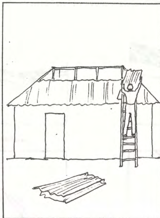
COLOQUE TEJA DE ABAJO HACIA ABAJO
