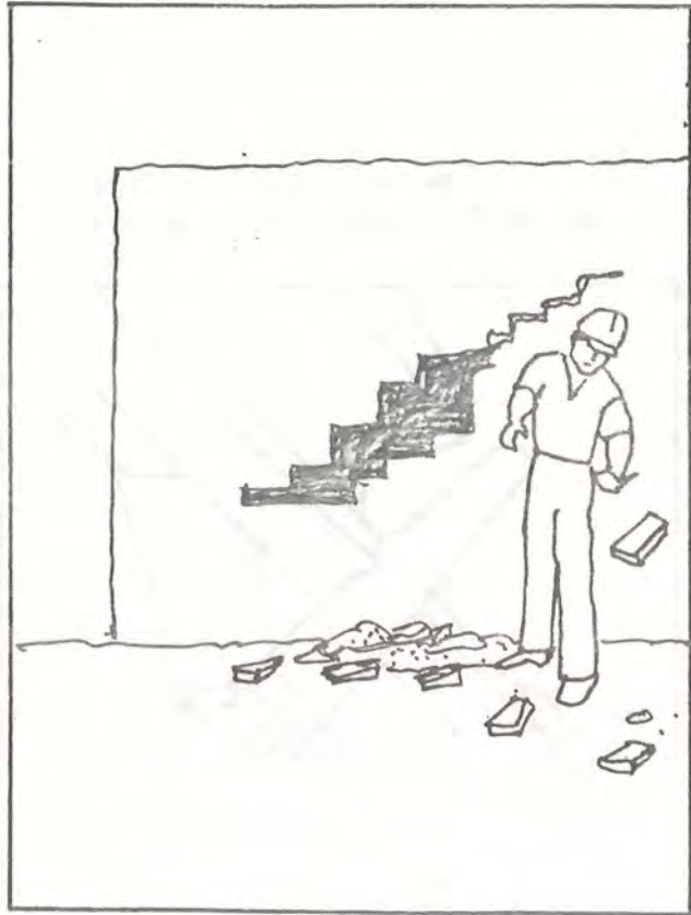
RETIRE LOS ADOBES DEL AREA MARCADA
