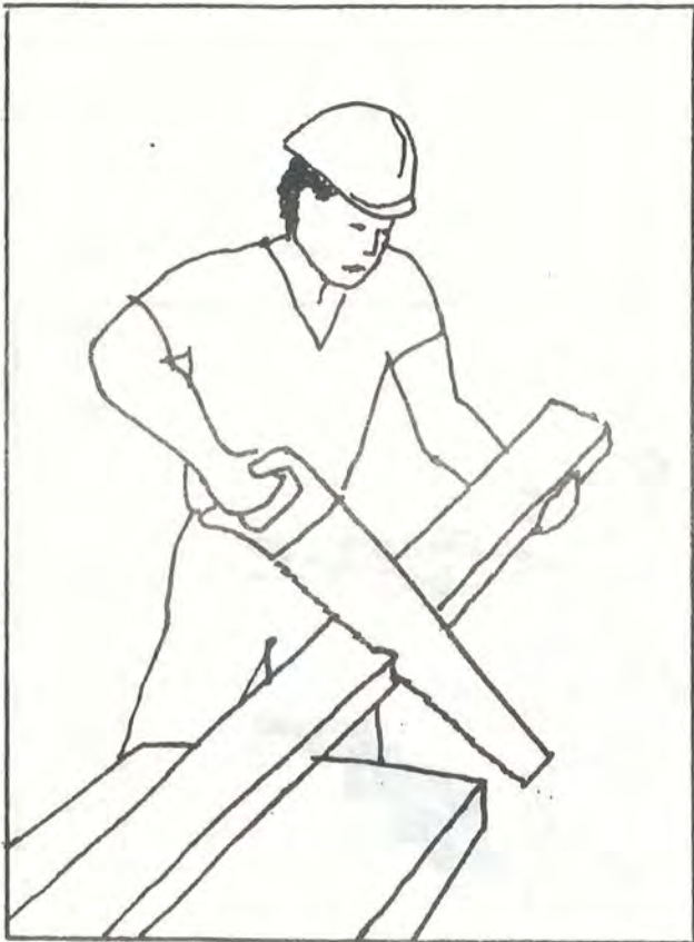
PREPARE MADERA PARA SOLERA CON EMPALME A MEDIA MADERA
