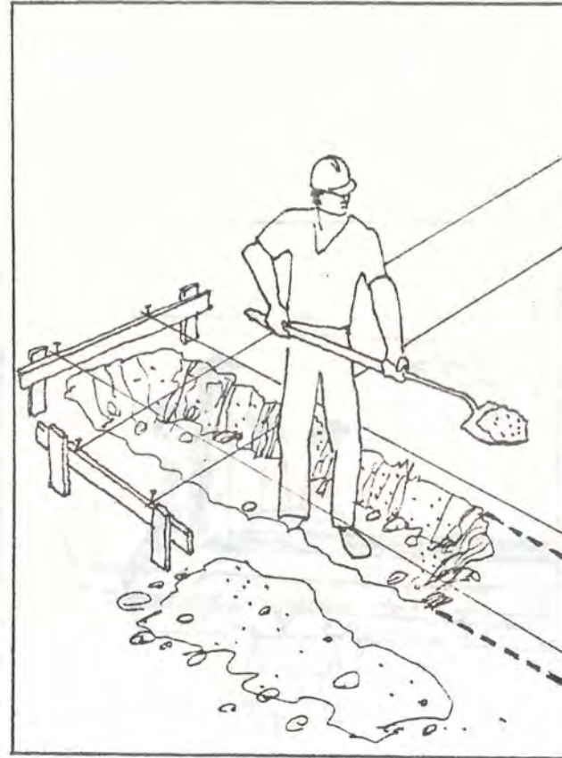
Marque en el terreno y haga excavación
