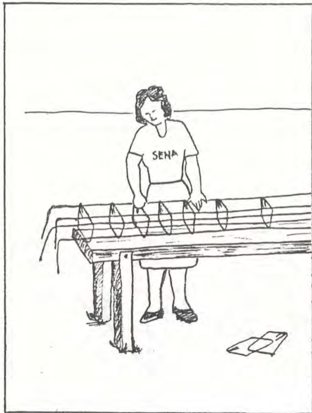
Construya armazón viga
