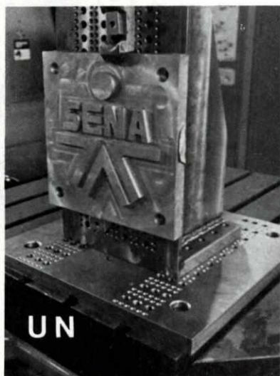
DISPOSITIVO CON DIVISOR BASCULANTE. Sistema de mon- taje que ofrece dos grados más de libertad - Posición vertical.
