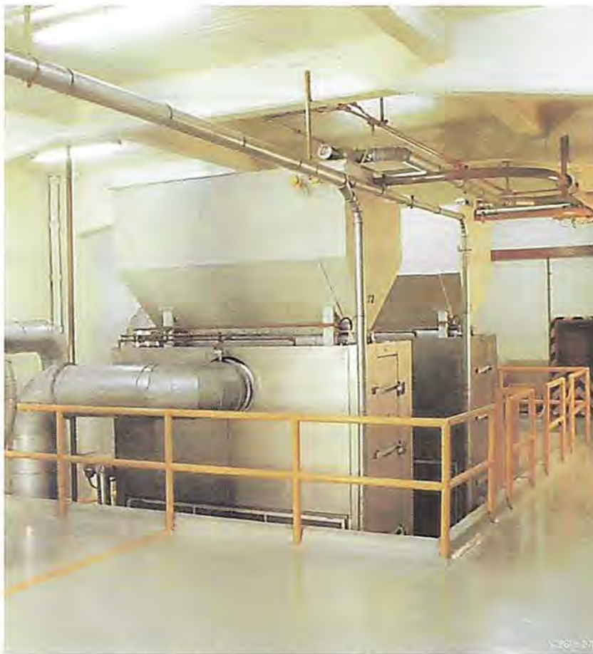
Figura 15. Tostador de cacao por aire caliente Fuente. Casa BUHLER.
