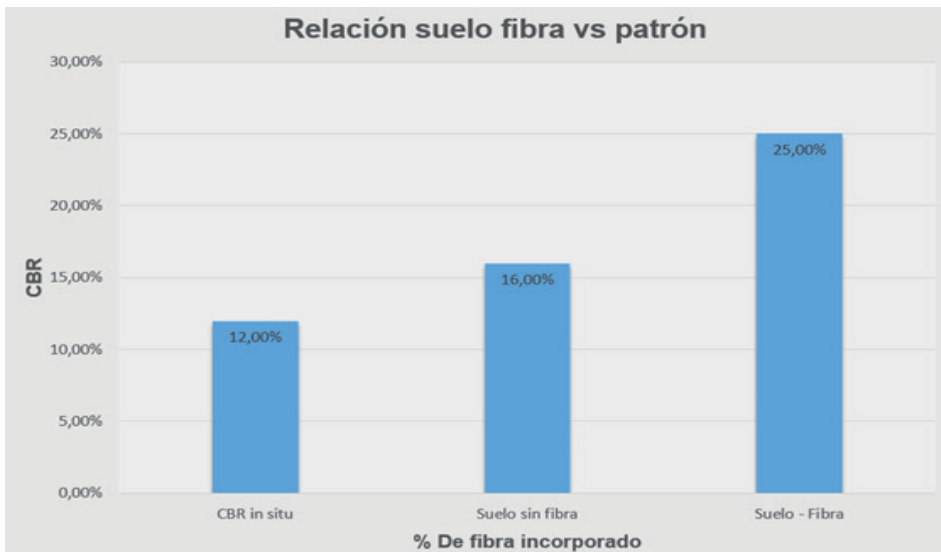
Figura 3. Resultados obtenidos en suelo arcilloso de baja plasticidad.
