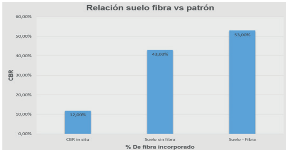
Figura 4. Resultados obtenidos en suelo arcilloso de alta plasticidad.
