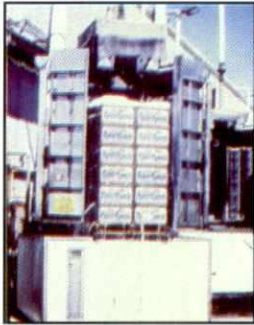
Diap. C.F. 3.7 Preenfriamiento con hielo en la parte superior de estibado
