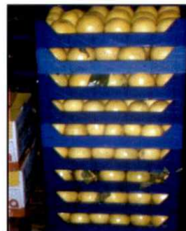
Diap. Em 3.15 Reforzamiento del sistema empaque- producto, mediante nervaduras verticales en las esquinas.
