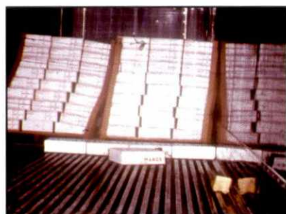
Diap. Em 4.7 Cuando se humedece el empaque en cartón pierde flexibilidad ocasionando la caída del arrume del estibado.
