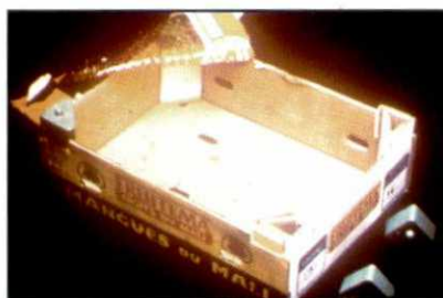
Diap. Em 4.8 La ubicación de uniones y anclajes se utilizan especialmente en cajas con grapas o alambres y no recomendable con puntillas.
