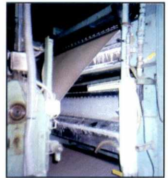
Diap. Em 3.3 Fabricación de las solapas y cajas troqueladas.
