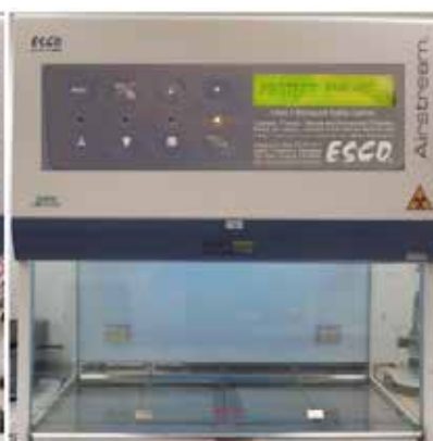
Figura 3. Cabina de flujo laminar. A. Cabina apagada con el flujo de aire prendido, LED indicador verde de encendido. B. Cabina con luz UV encendida, LED indicador naranja encendido. C. Cabina con luz blanca encendida, LED indicador azul encendido.
