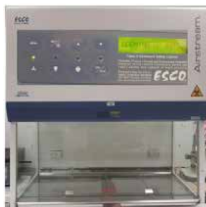
Figura 3. Cabina de flujo laminar. A. Cabina apagada con el flujo de aire prendido, LED indicador verde de encendido. B. Cabina con luz UV encendida, LED indicador naranja encendido. C. Cabina con luz blanca encendida, LED indicador azul encendido.
