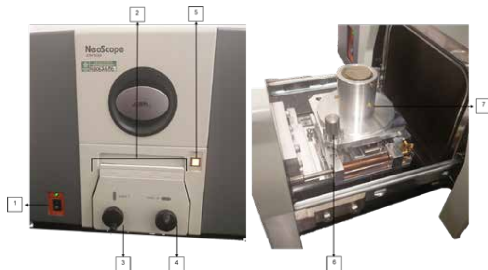
Figura. Partes principales del SEM JEOL JCM 5000 de Tecnoacademia Neiva.
