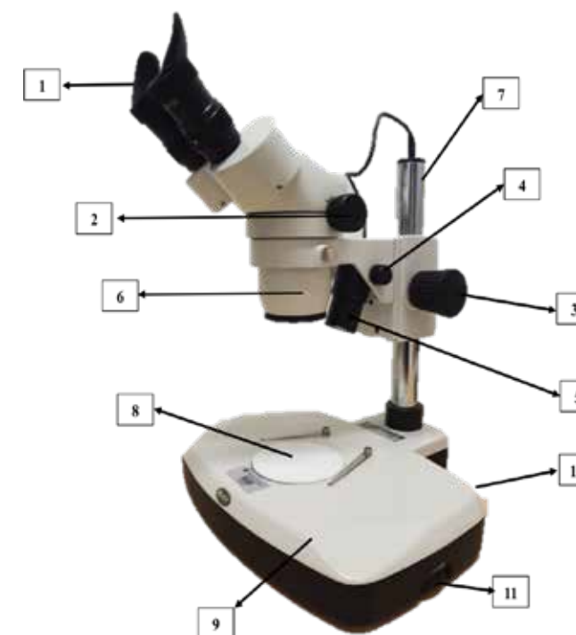
Figura 2. Partes de un estereomicroscopio óptico. Equipo MOTIC utilizado en el laboratorio de Tecnoacademia-Neiva.
