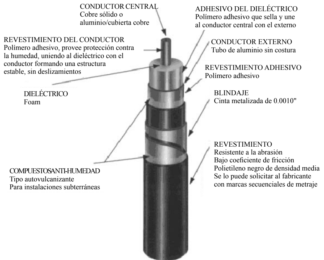
Figura 26. Constitución del cable rígido
