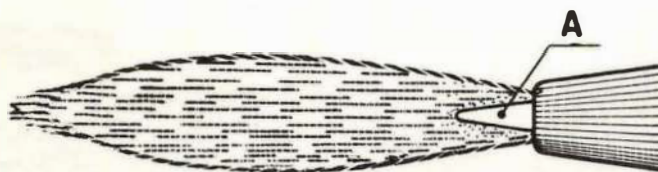
FIG. 3 LLAMA CARBURANTE Llama con exceso de acetileno, se distingue por un cono largo brillante A y un cono secundario B luminoso.
