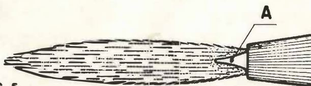
FIG. 5 LLAMA OXIDANTE Aumentando el oxígeno, se forma ésta llama que se distingue: por el acortamiento, aguzamiento y reducción de luminosidad en su cono A, además produce un ruido agudo.
