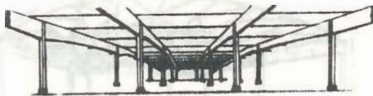
Galpón industrial constituido por vigas "cantilever". Luz : 10 a 25 m.
