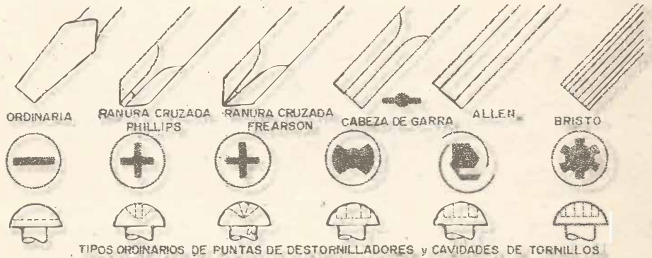
TIPOS ORDINARIOS DE PUNTAS DE DESTORNILLADORES y CAVIDADES DE TORNILLOS
