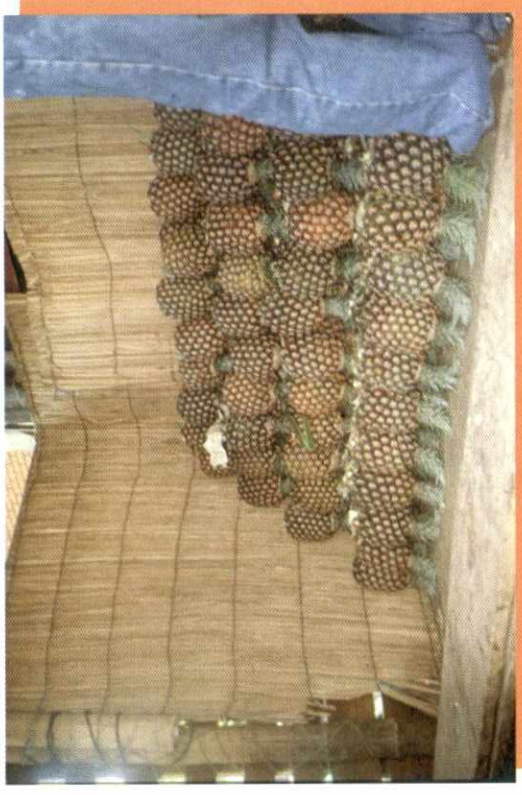
Pi D-4.4 Además se coloca un sistema de amortiguación para que las piñas no estén en contacto directo con la carrocería
